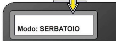
La videata indica che è avvenuto il cambio di modalità da rete idrica a serbatoio
