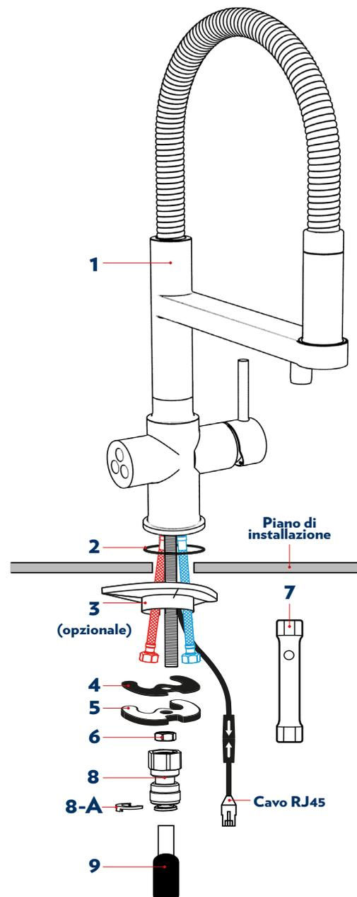
5. Infilare da sotto il lavandino, centrando il tubo filettato, la guarnizione in gomma **4** e poi la piastra metallica **5** e infine avvitare il dado **6**.
